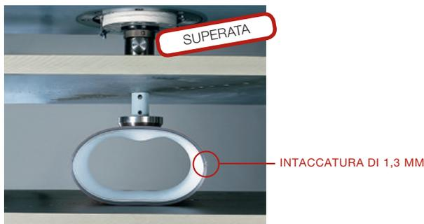
Prova di resistenza a carico concentrato con intaglio laterale (FIGURA 2)
