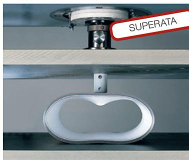
Prova di resistenza a perforazione con punzone (FIGURA 1)
